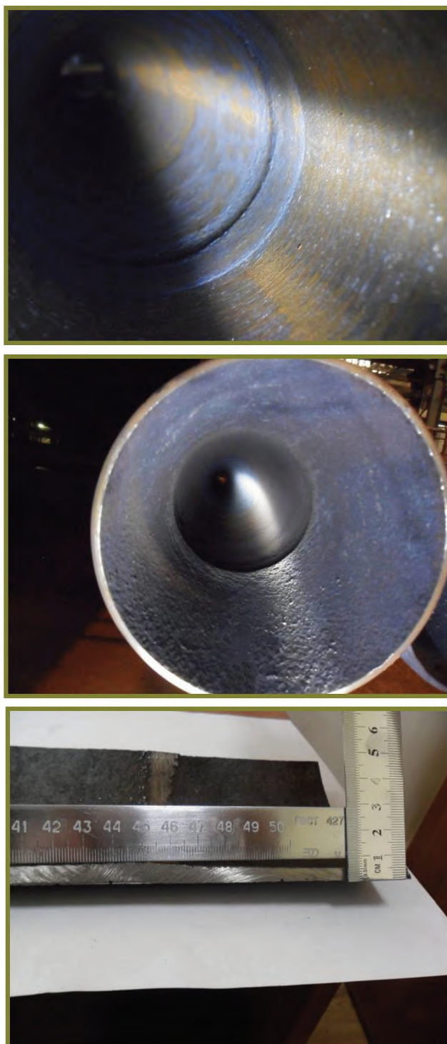
Рисунок Д.10 — Нарост, залив, грубая поверхность
