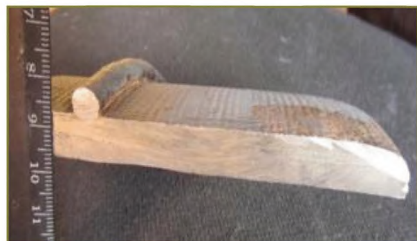
Рисунок Д.7 — Утонение гладкого конца трубы
