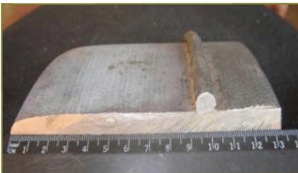
Рисунок Д.7 — Утонение гладкого конца трубы
